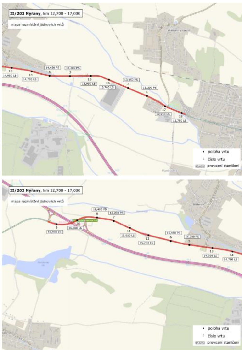
Obr. 1 - Situace úseku včetně vyznačení odebraných jádrových vývrtů
