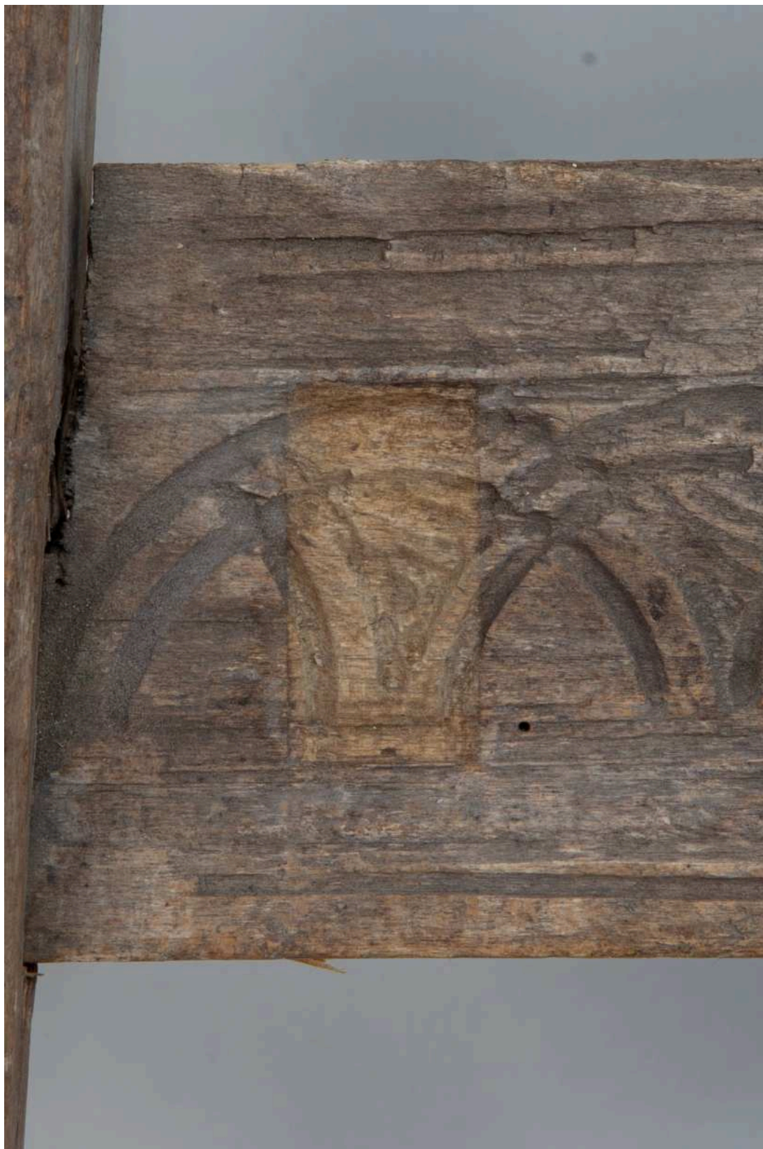
S12 - zkouška snímání prachových depositů - Trakař s dekorem 34/62 - střed
