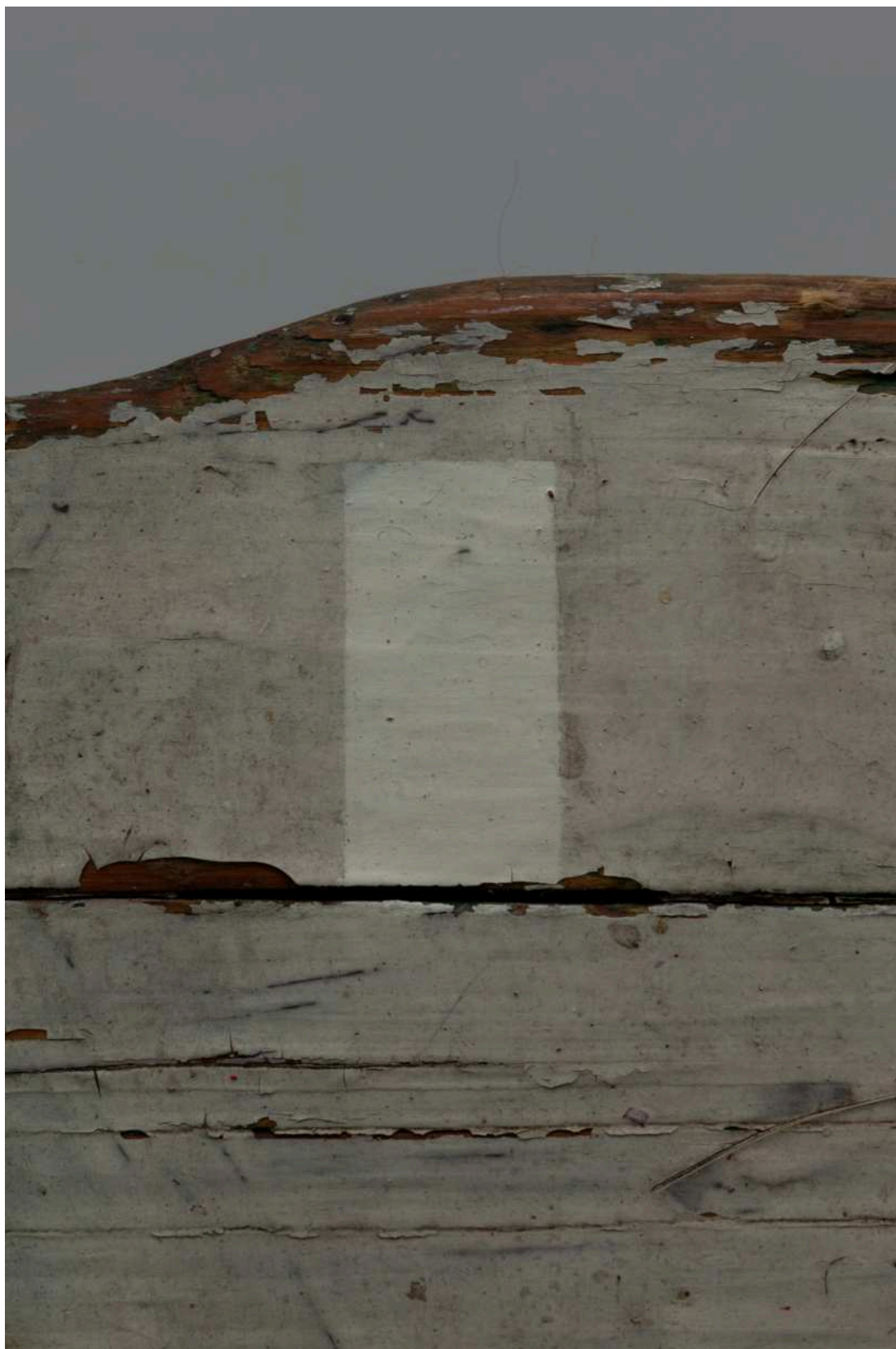
S11 - zkouška snímání prachových depositů - Kolébka 155/64 - čelo
