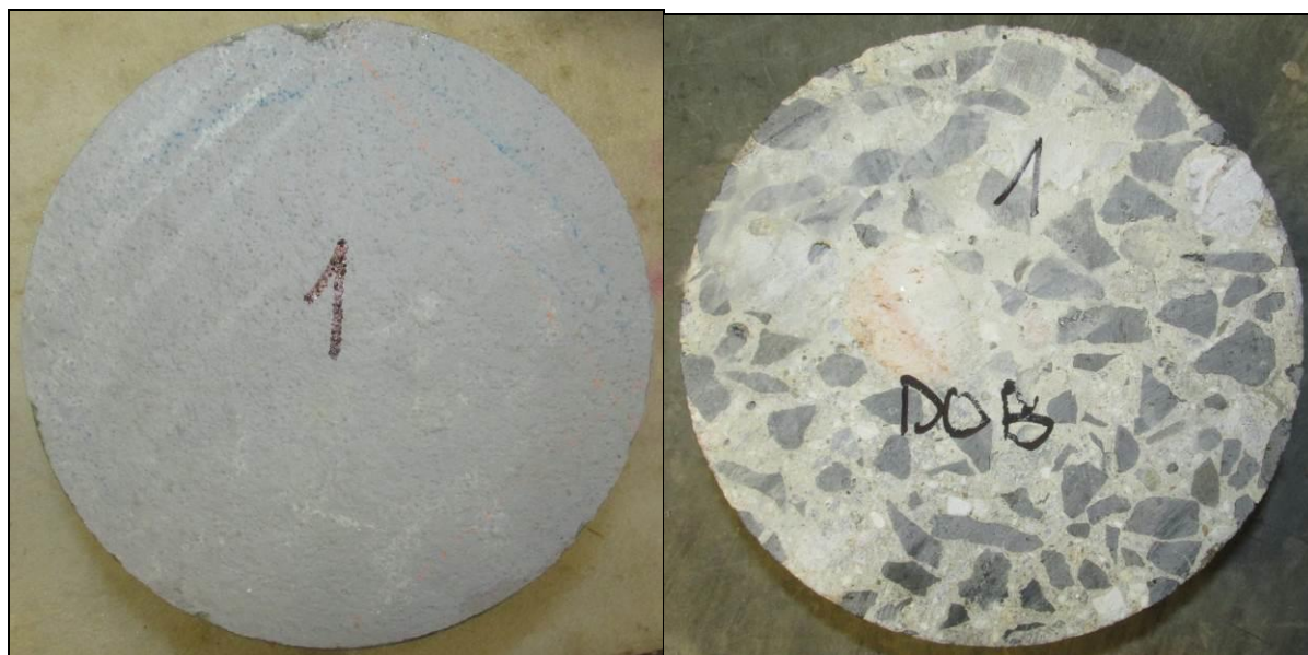
Foto 6: Celkový pohled na čelo vývrtnu CHRL1 před zkouškou (před a po odříznutí vrstvy sanace na líci vývrtnu)
