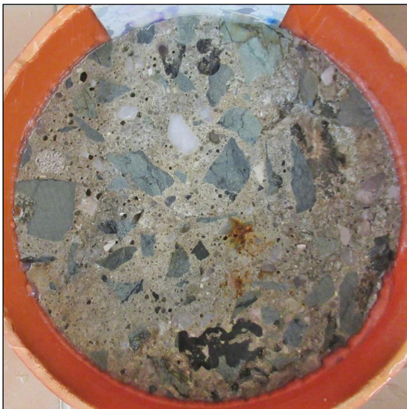
Foto 8: Líc vzorku V8 po zkoušce – 75 cyklů celkový odpad 301 g/m 2
