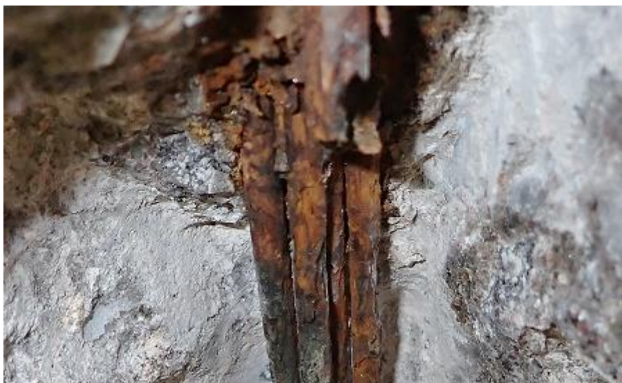
Obr. 5. Příklad rozsáhlého „pittingu“ vedoucího k lokální perforaci stěny jednotlivých segmentů
