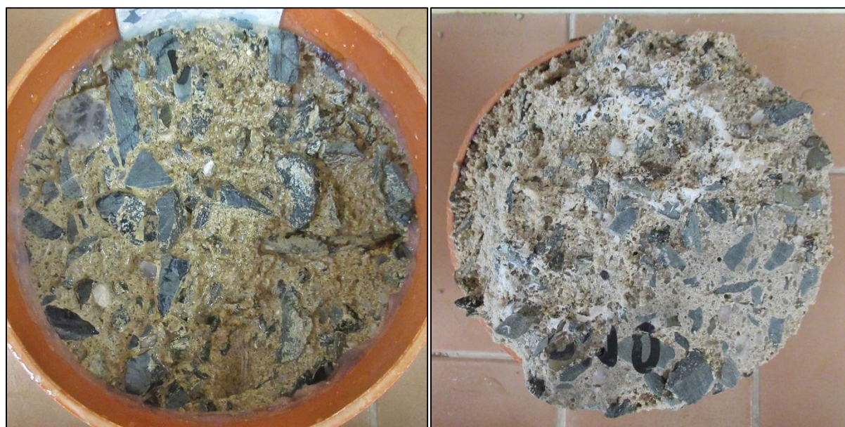
Foto 2: Líc (vlevo) a rub (vpravo) vzorku V2 po zkoušce – 75 cyklů celkový odpad 9918 g/m 2
