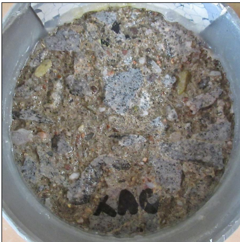
Foto 4: Líc vzorku V4 po zkoušce – 75 cyklů celkový odpad 1139 g/m 2
