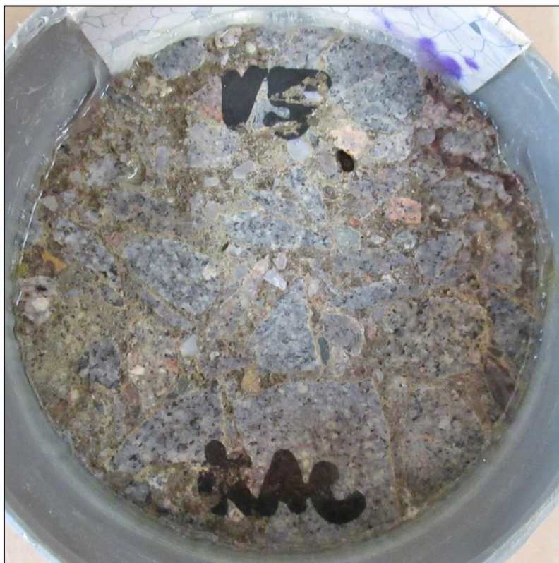
Foto 6: Líc vzorku V5 po zkoušce – 75 cyklů celkový odpad 79 g/m 2
