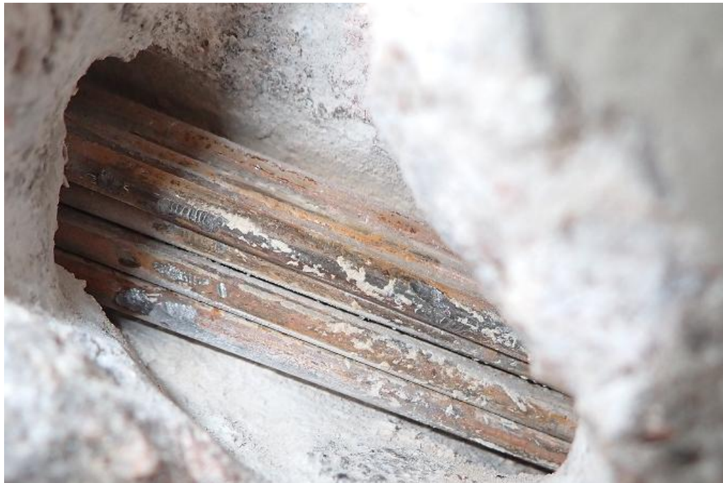
Obr. 4. Povrchové korozní poškození jednotlivých drátů předpínací výztuže s počátečními náznaky „pittingu“ (stimulační lokalizované působení chloridových aniontů)
