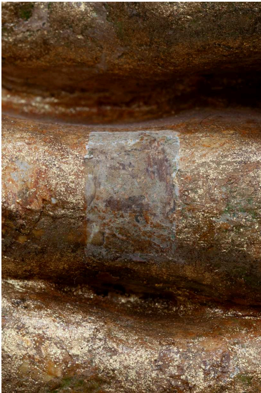
S03 - zkouška snímání mladších barevných vrstev - prst (levá ruka)
