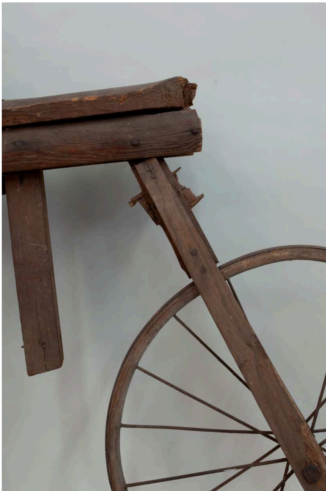
Stav před restaurováním - Celodřevěné kolo - 1665 - zadní vidlice
