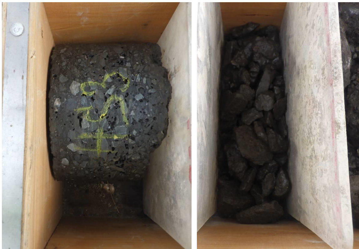
Detail asfaltových vrstev HS 3-1 a vrstvy HS 3-2
