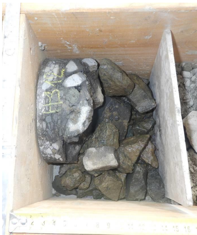
Detail asfaltových vrstev HS 12-1 a vrstvy HS 12-2
