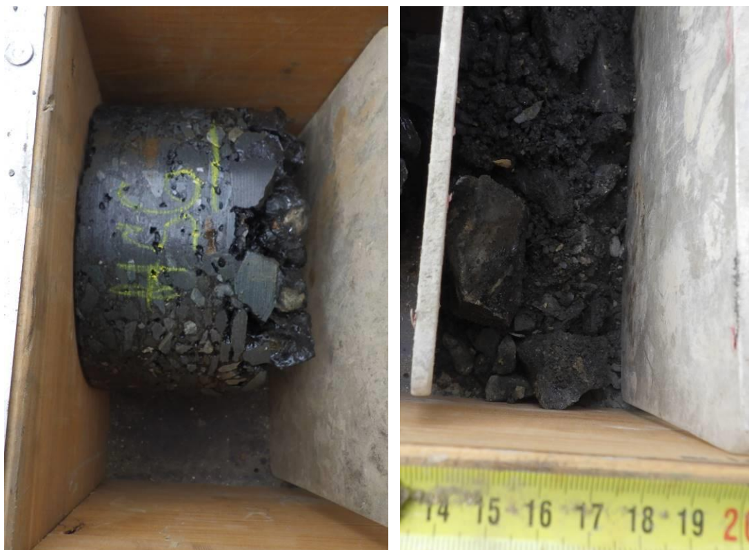
Detail asfaltových vrstev HS 6-1 a vrstvy HS 6-2
