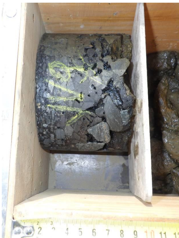
Detail asfaltových vrstev HS 9-1
