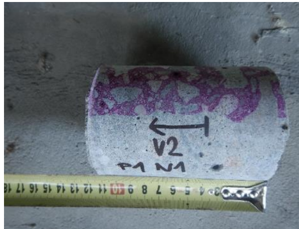
Obr. 5.1-2: Vzorek betonu V2 o \varnothing 75 mm odebraný v prvním poli z fasádní stěny nosníku N1 v oblasti jeho konce u Op1.
