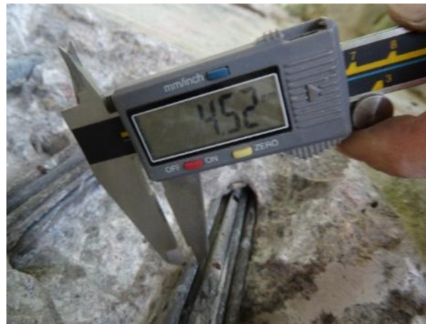
Obr. 136: S NK 20, K2. Měření \varnothing předpínacího drátu.
