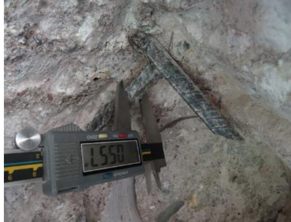
Obr. 14: S ss2 . Zjištěný \varnothing vodorovné výztuže (zobrazovaná hodnota v palcích). Zjištěný \varnothing po převodu je 14,15 mm.
