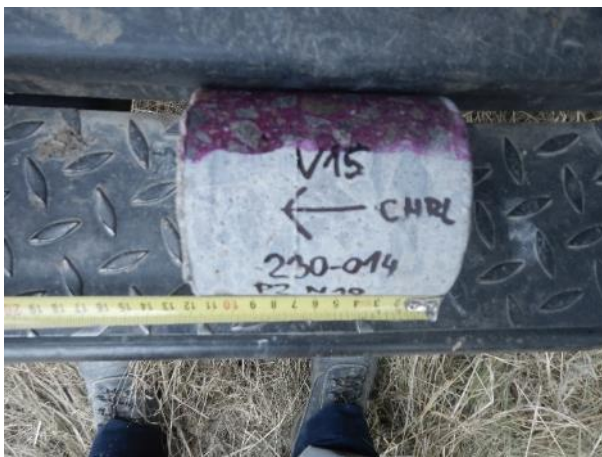
Obr. 5.1-15: Vzorek betonu V15 o \varnothing 100 mm odebraný v 2. poli z fasádní stěny nosníku N10 v oblasti jeho středu.
