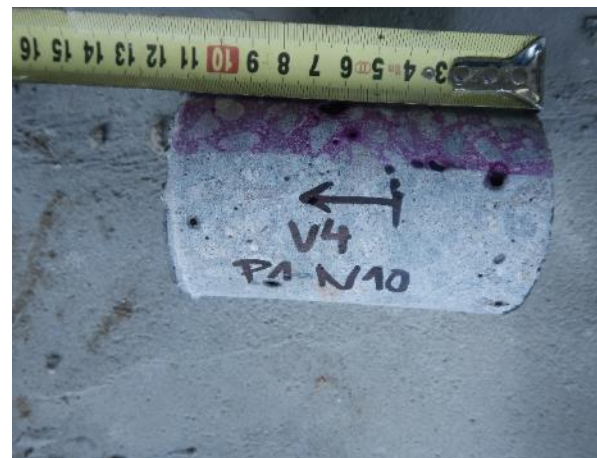
Obr. 5.1-4: Vzorek betonu V4 o \varnothing 75 mm odebraný v prvním poli z fasádní stěny nosníku N10 v oblasti jeho konce u Op1.
