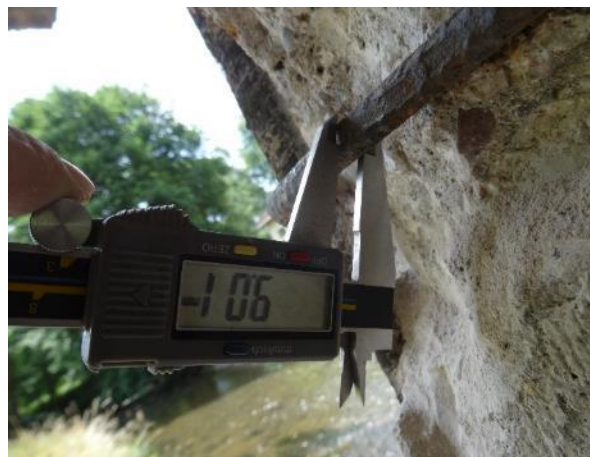
Obr. 56: S SS8 . Zjištěný \varnothing obvod. třmínku.
