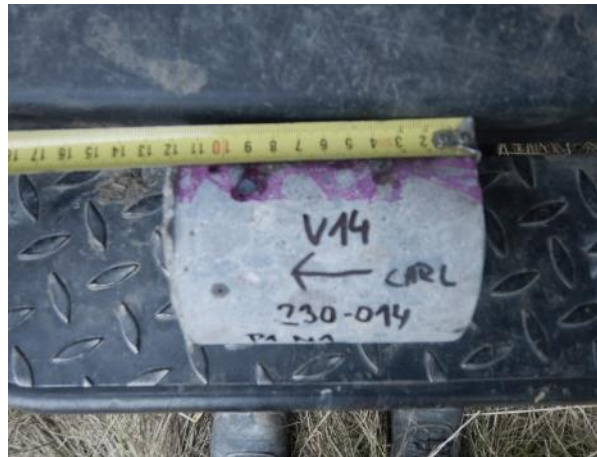
Obr. 5.1-14: Vzorek betonu V14 o \varnothing 100 mm odebraný v 1. poli z fasádní stěny nosníku N1 v oblasti jeho středu.
