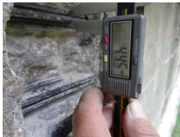
Obr. 72: S NK11 . K2P. Měření \varnothing předpínacího drátu.
