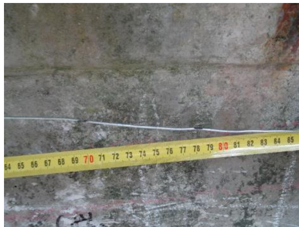
Obr. 156: Změřená délka prostupu ocel. lanka nevyplněným kanálkem v obou směrech měření odečtená z rysek na ocel. lanku.
