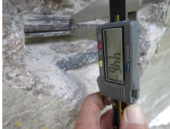
Obr. 74: SNK11. K3P. Měření \varnothing předpínacího drátu.
