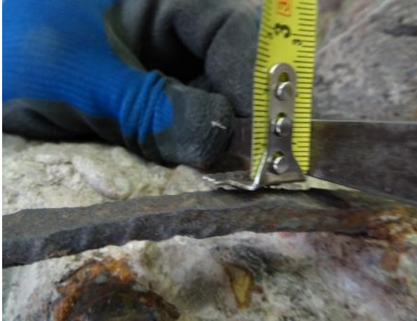
Obr. 43: S ss6 . Měření krycí vrstvy třmínku ve svislé rovině.
