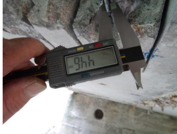
Obr. 56: S NK8 , K4. Měření \varnothing předpínacího drátu.
