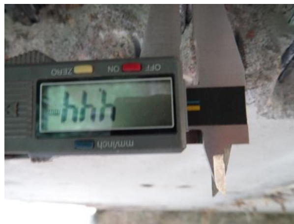
Obr. 54: SNK8, K5. Měření \varnothing předpínacího drátu.
