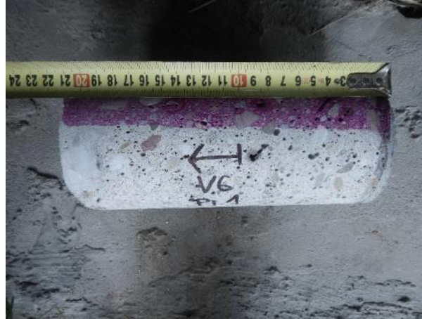
Obr. 5.1-6: Vzorek betonu V6 o \varnothing 100 mm odebraný z levé stojky Pi2.
