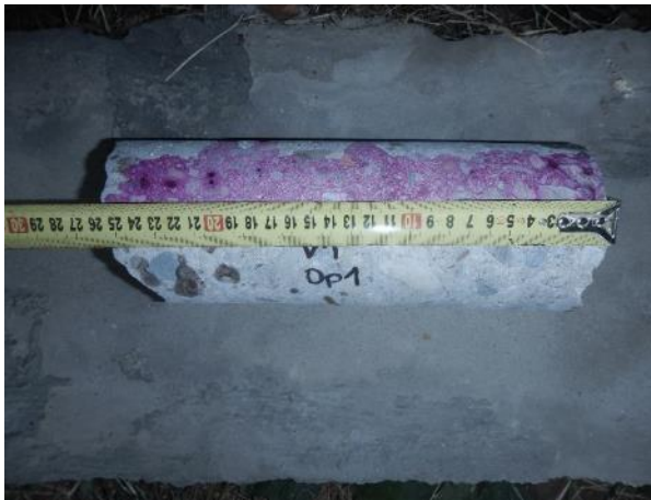
Obr. 5.1-1: Vzorek betonu V1 o \varnothing 100 mm odebraný z Op1.
