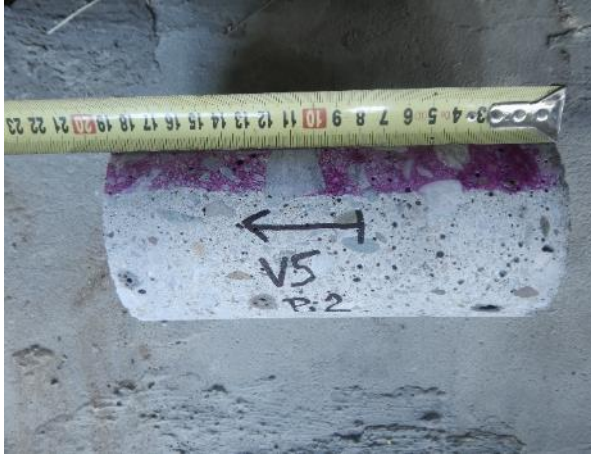
Obr. 5.1-5: Vzorek betonu V5 o \varnothing 100 mm odebraný z pravé stojky Pi2.
