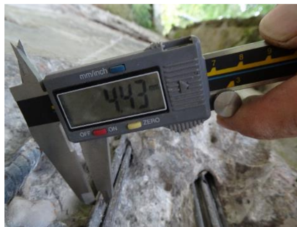
Obr. 138: S NK 20, K3. Měření \varnothing předpínacího drátu.
