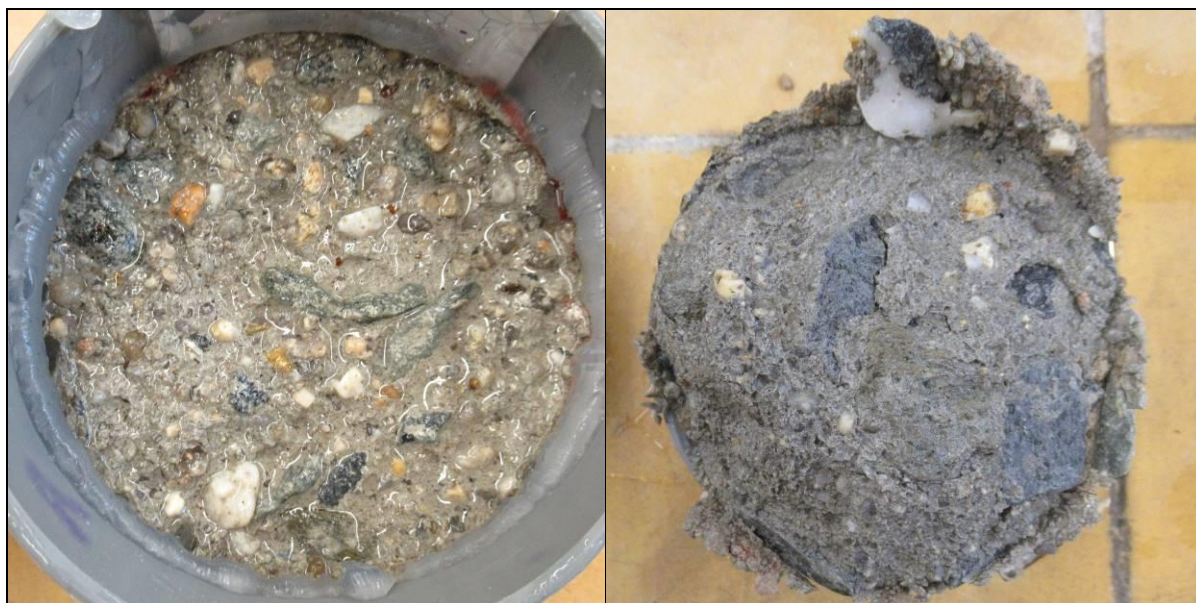
Foto 21: Líc (vlevo) a rub (vpravo) vzorku CHRL6 po zkoušce – 50 cyklů
