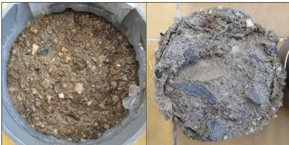
Foto 11: Líc (vlevo) a rub (vpravo) vzorku CHRL1 po zkoušce – 50 cyklů Celkový odpad 2976 g/m 2 Zaznamenán rozpad čelní i rubové plochy zkušebního tělesa
