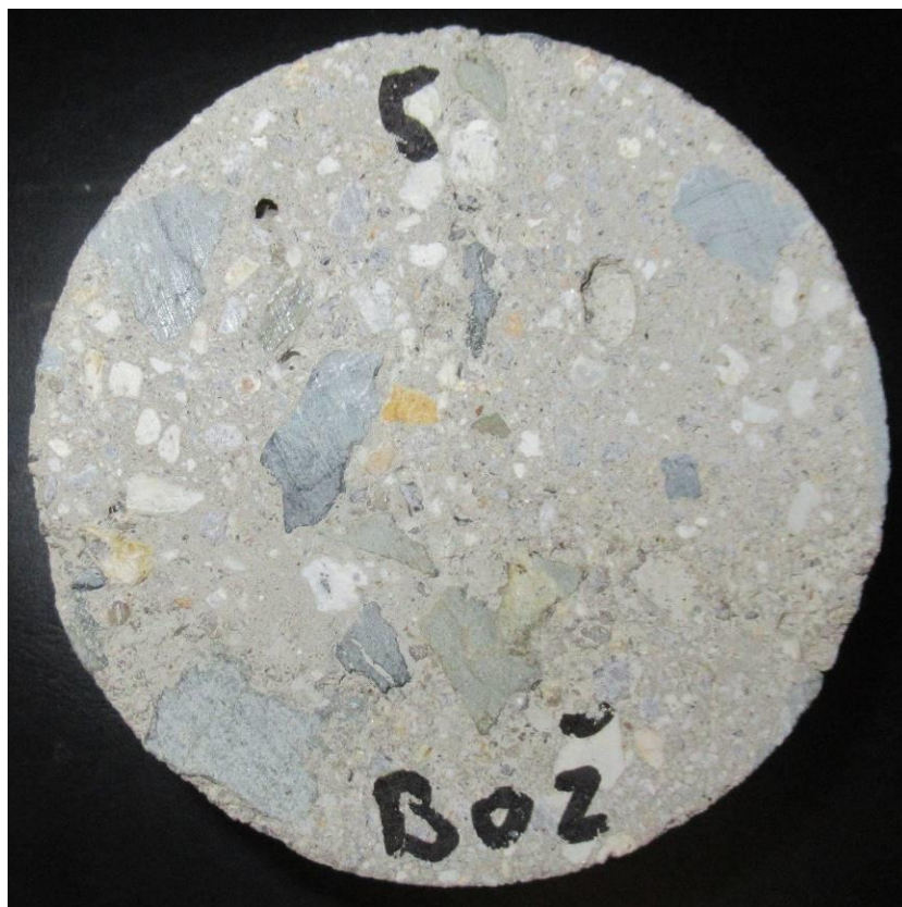
Foto 18: Čelo vzorku CHRL5 před zkouškou
