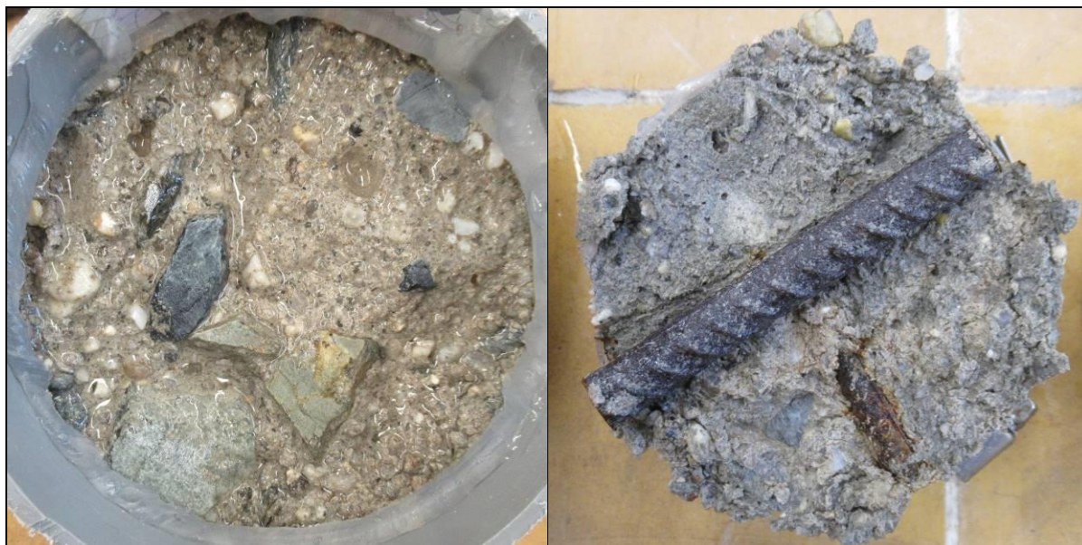
Foto 19: Líc (vlevo) a rub (vpravo) vzorku CHRL5 po zkoušce – 50 cyklů Celkový odpad 4472 g/m 2 Zaznamenán rozpad čelní i rubové plochy zkušebního tělesa
