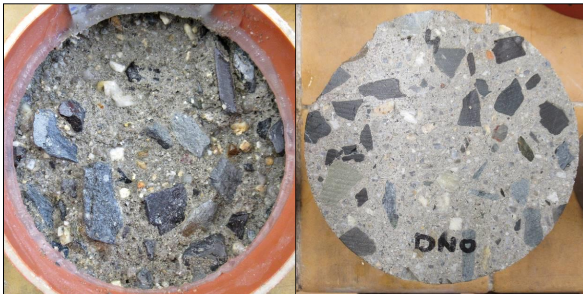
Foto 17: Líc (vlevo) a rub (vpravo) vzorku CHRL4 po zkoušce – 50 cyklů Celkový odpad 8817 g/m 2
