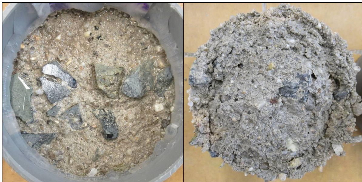
Foto 13: Líc (vlevo) a rub (vpravo) vzorku CHRL2 po zkoušce – 50 cyklů Celkový odpad 3508 g/m 2 Zaznamenán rozpad čelní i rubové plochy zkušebního tělesa
