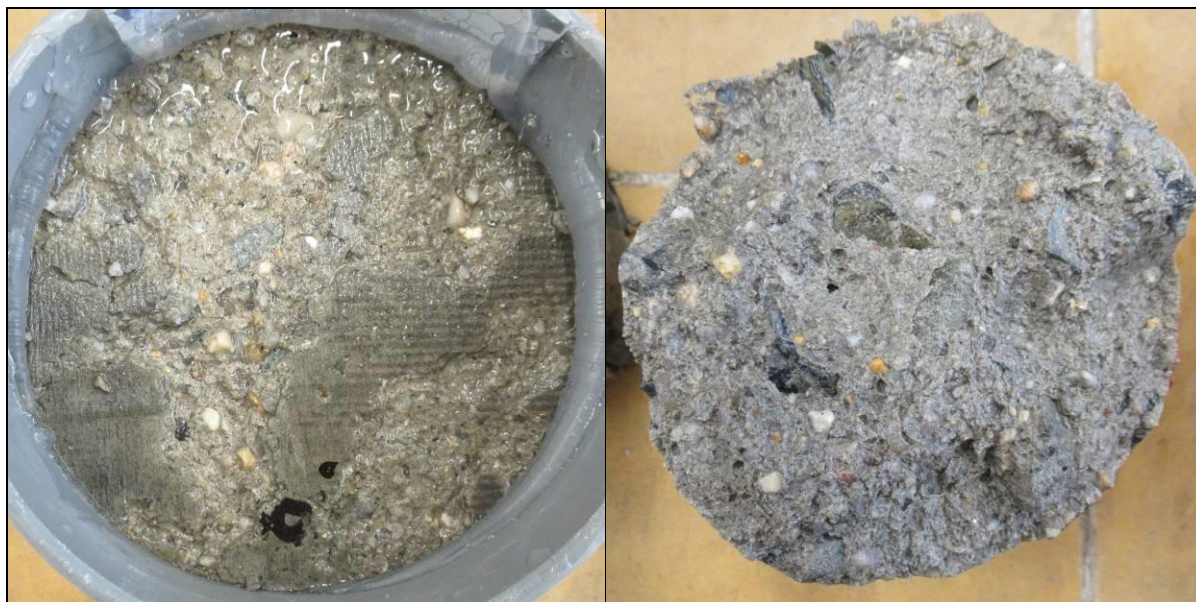
Foto 15: Líc (vlevo) a rub (vpravo) vzorku CHRL3 po zkoušce – 50 cyklů Celkový odpad 1627 g/m 2 Zaznamenán rozpad rubové plochy zkušebního tělesa
