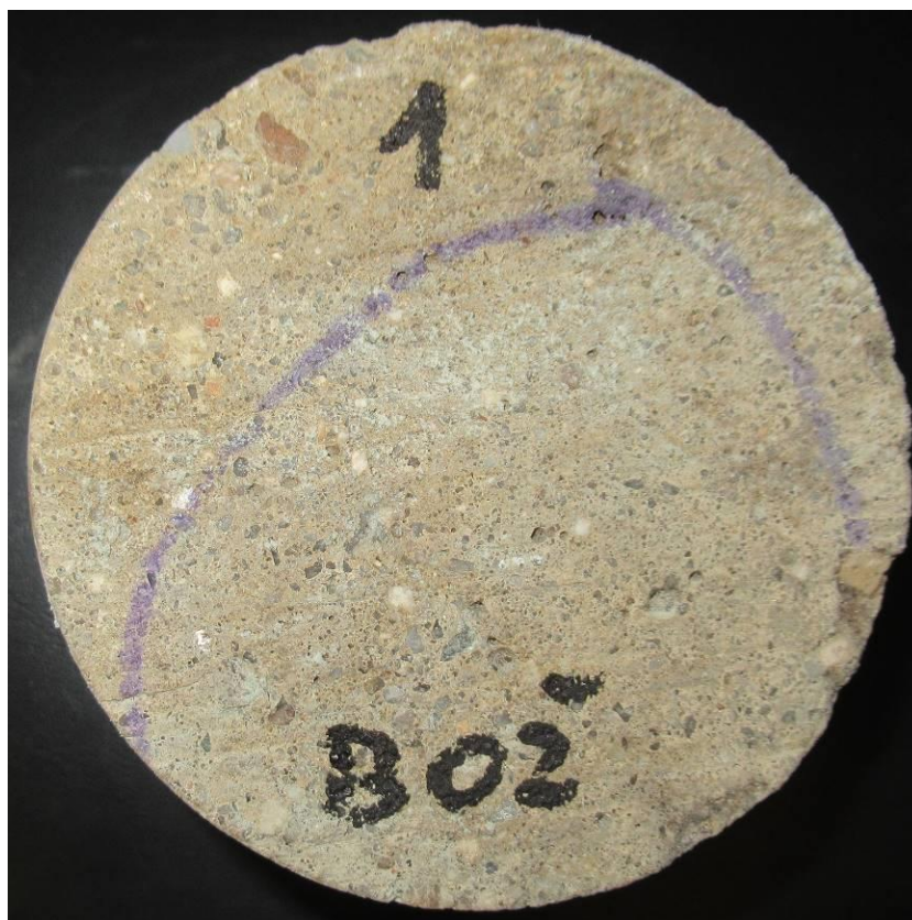
Foto 10: Čelo vzorku CHRL1 před zkouškou
