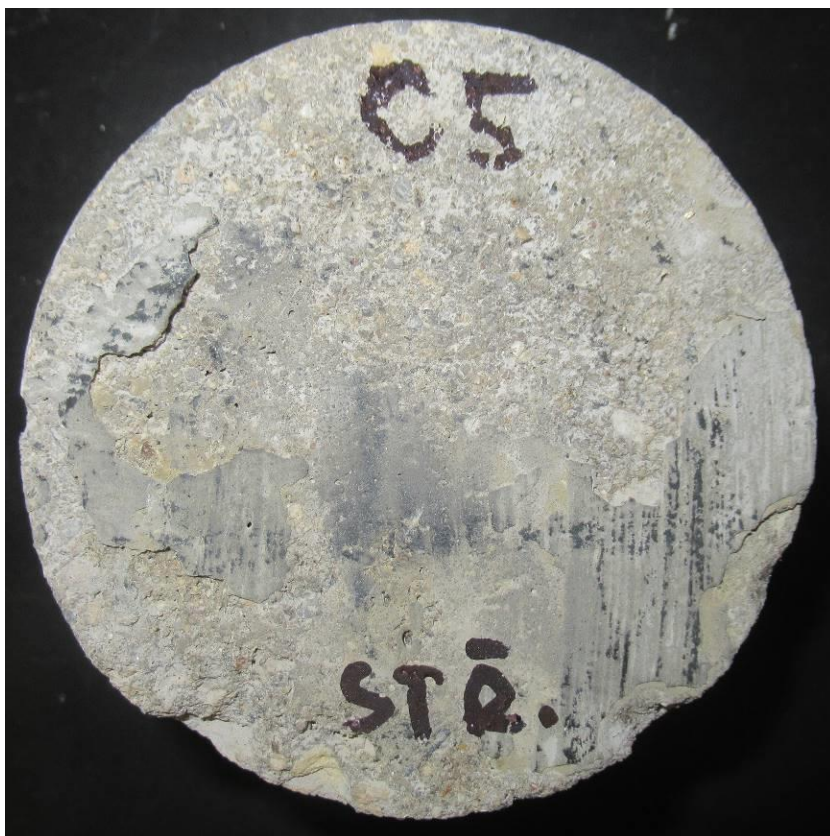
Foto 16: Líc vývrtu C5 před zkouškou
