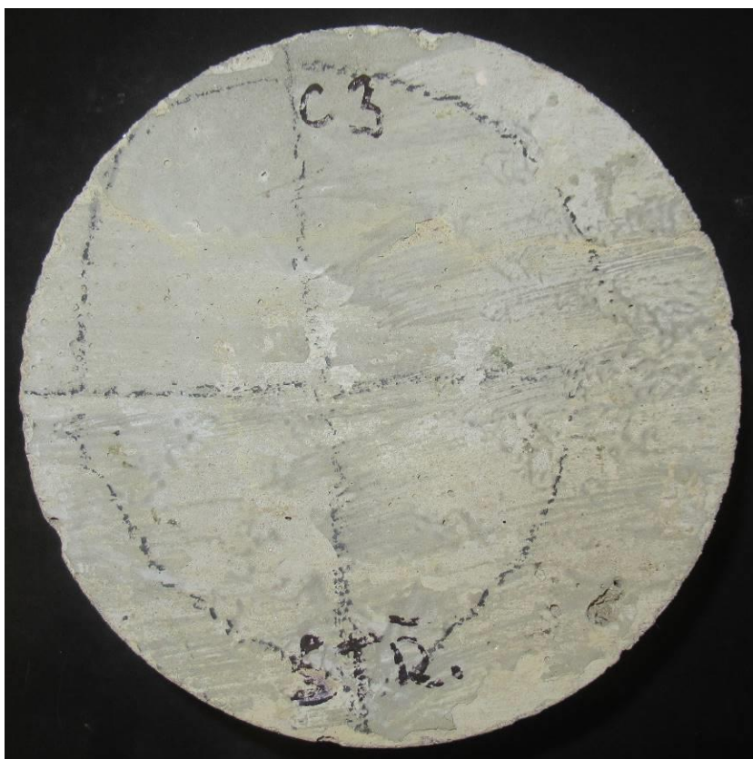
Foto 18: Líc vývrtnu C3 před zkouškou
