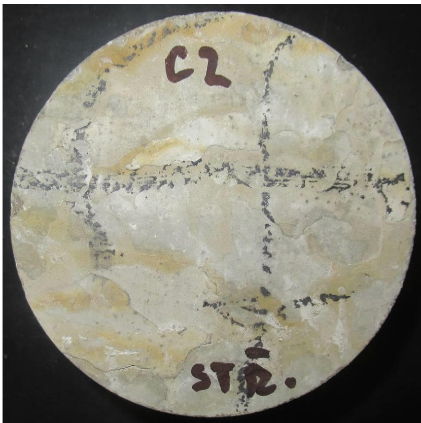
Foto 12: Líc vývrtu C2 před zkouškou
