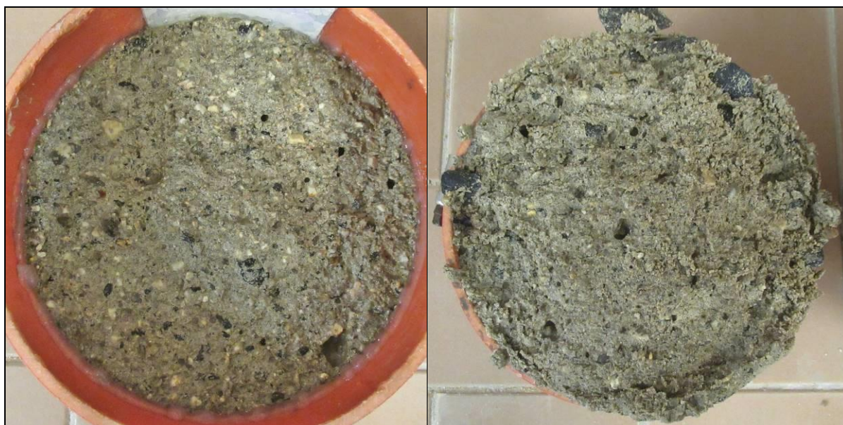
Foto 19: Líc (vlevo) a rub (vpravo) vzorku C3 po zkoušce – 75 cyklů celkový odpad 5838 g/m 2
