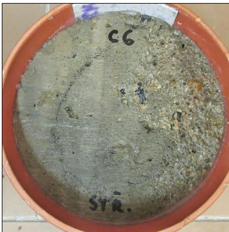
Foto 21: Líc vzorku C6 po zkoušce – 75 cyklů celkový odpad 987 g/m 2 Zaznamenán částečný rozpad lící plochy vzorku
