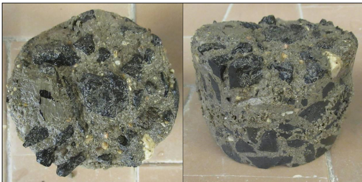
Foto 15: Líc (vlevo) a pohled na vzorek (vpravo) C4 po zkoušce – 100 cyklů celkový odpad 10198 g/m 2 Zaznamenán celkový rozpad čela a počátek rozpadu vzorku
