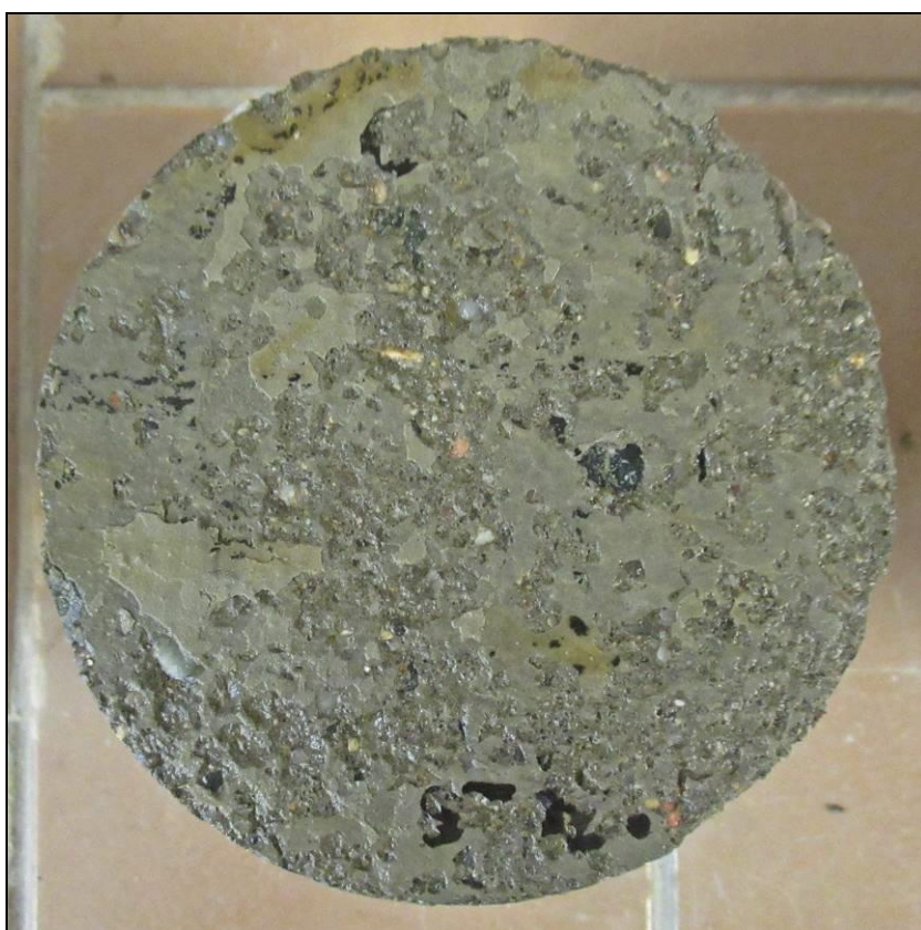
Foto 13: Líc vzorku C2 po zkoušce – 100 cyklů celkový odpad 596 g/m 2
