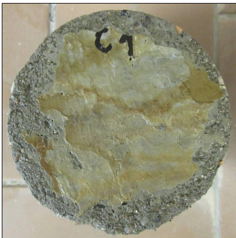
Foto 11: Líc vzorku C1 po zkoušce – 100 cyklů celkový odpad 646 g/m 2
