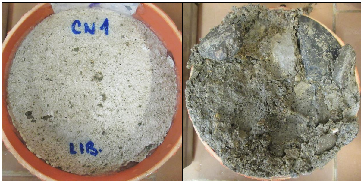
Foto 19: Líc (vlevo) a rub (vpravo) vzorku Cn1 po zkoušce – 75 cyklů celkový odpad 12 g/m 2
