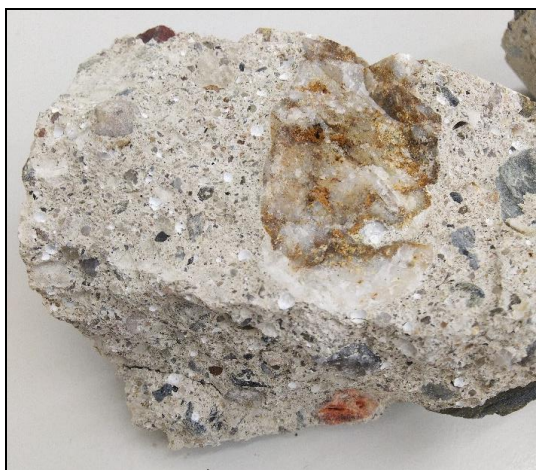
Foto 46: Vzorek Vn4 – bílé výluhy v pórech
