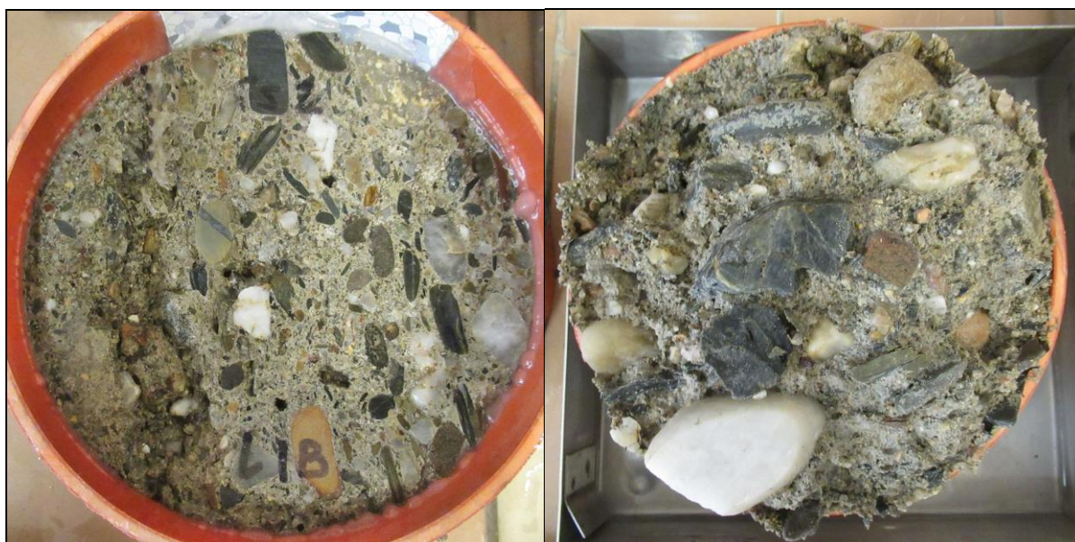
Foto 33: Líc (vlevo) a rub (vpravo) vzorku Cs2 po zkoušce – 75 cyklů celkový odpad 1689 g/m 2
