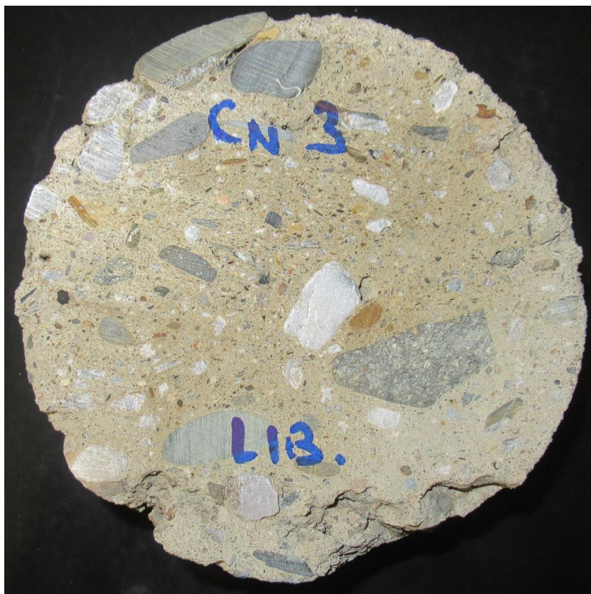
Foto 22: Líc vývrtu Cn3 před zkouškou
