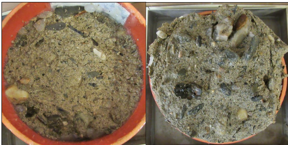
Foto 23: Líc (vlevo) a rub (vpravo) vzorku Cn3 po zkoušce – 75 cyklů celkový odpad 7784 g/m 2
