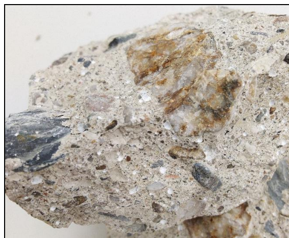
Foto 47: Vzorek Vn4 – bílé výluhy v pórech
