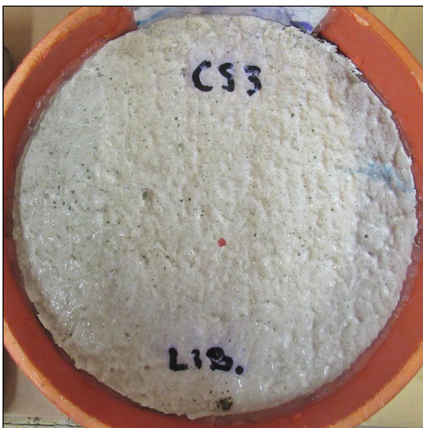
Foto 35: Líc vzorku Cs3 po zkoušce – 75 cyklů celkový odpad 12 g/m 2
