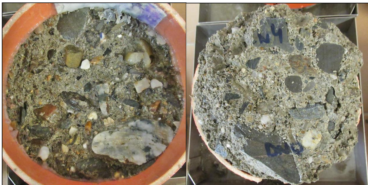
Foto 25: Líc (vlevo) a rub (vpravo) vzorku Cn4 po zkoušce – 75 cyklů celkový odpad 6994 g/m 2
