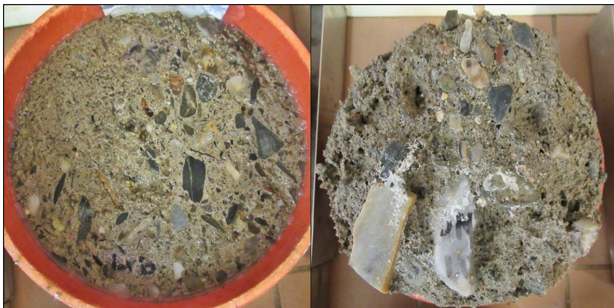
Foto 37: Líc (vlevo) a rub (vpravo) vzorku Cs4 po zkoušce – 75 cyklů celkový odpad 687 g/m 2
